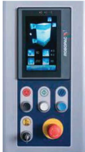
Panel táctil con tecnología "Multilevel Control". Painel touch screen com tecnologia "Multilevel Control".
