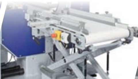
CINTA TRANSPORTADORA HORIZONTAL MOTORIZADA DE ANCHO REGULABLE TRANSPORTADOR HORIZONTAL DE ESTEIRAS MOTORIZADAS DE LARGURA REGULÁVEL
